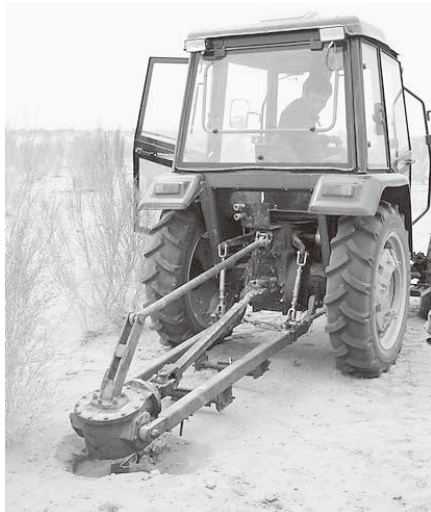
図 5. 地面に穴を掘る機械
