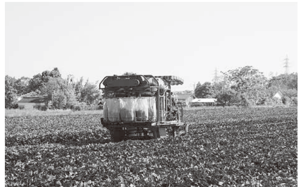
図5. 乗用摘採機による収穫の様子
