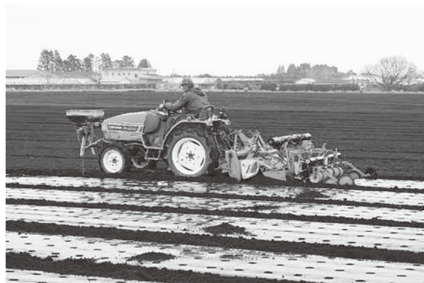
図1. 施肥・耕うん・畝立て・マルチ張り・播種を同時に行うトラクター
